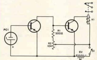
Fig. 4 - Fotorelé con un preciso controllo della sensibilità in R2.
