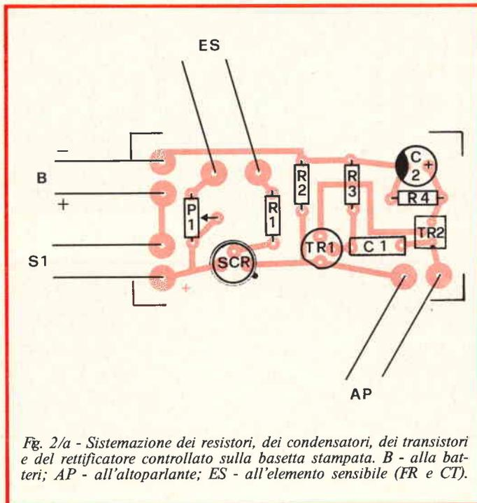
Fig. 2/a - Sistemazione dei resistori, dei condensatori, dei transistori e del rettificatore controllato sulla bassetta stampata. B - alla batteria; AP - all'altoparlante; ES - all'elemento sensibile (FR e CT).
