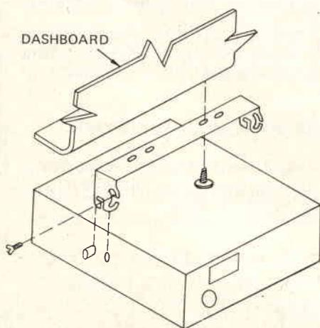
Fig. 3 - Esempio di fissaggio sul sotto plancia.
