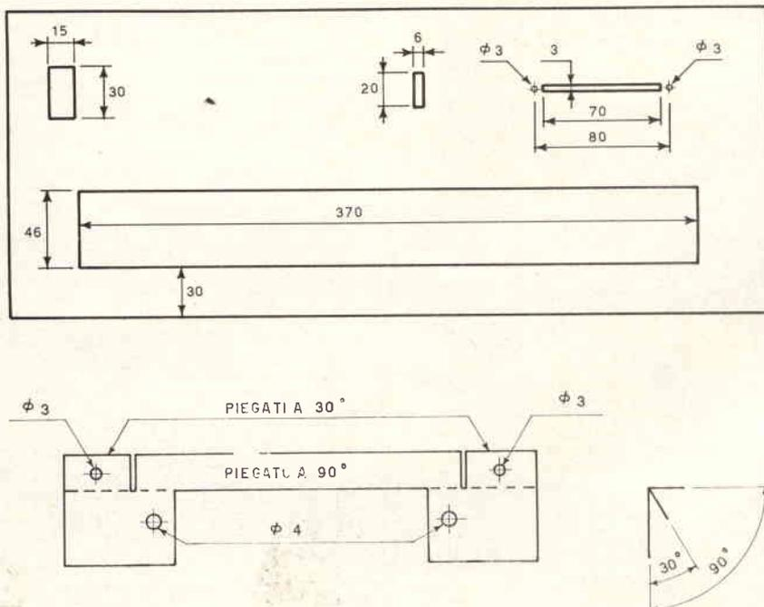
Fig. 2 - Piano di foratura del pannello frontale.
