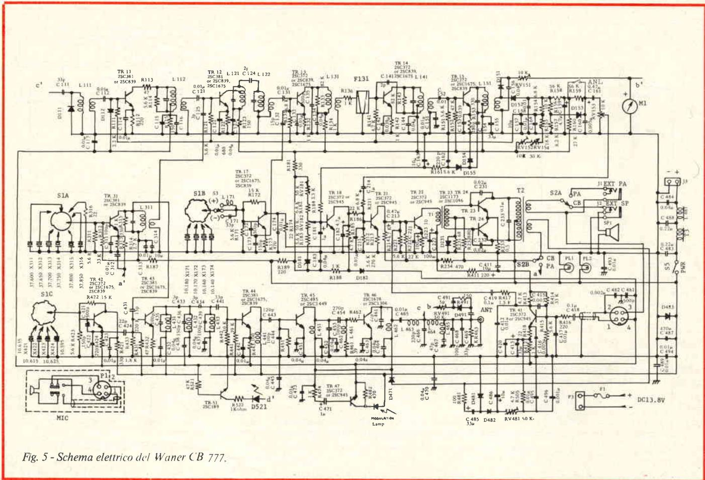
Fig. 5 - Schema elettrico del Waner CB 777.
