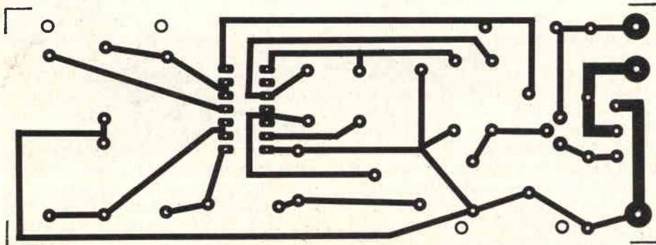
Fig. 2 - Disegnò delle piste ramate sulla basetta stampata relativa al circuito di fig. 1.
