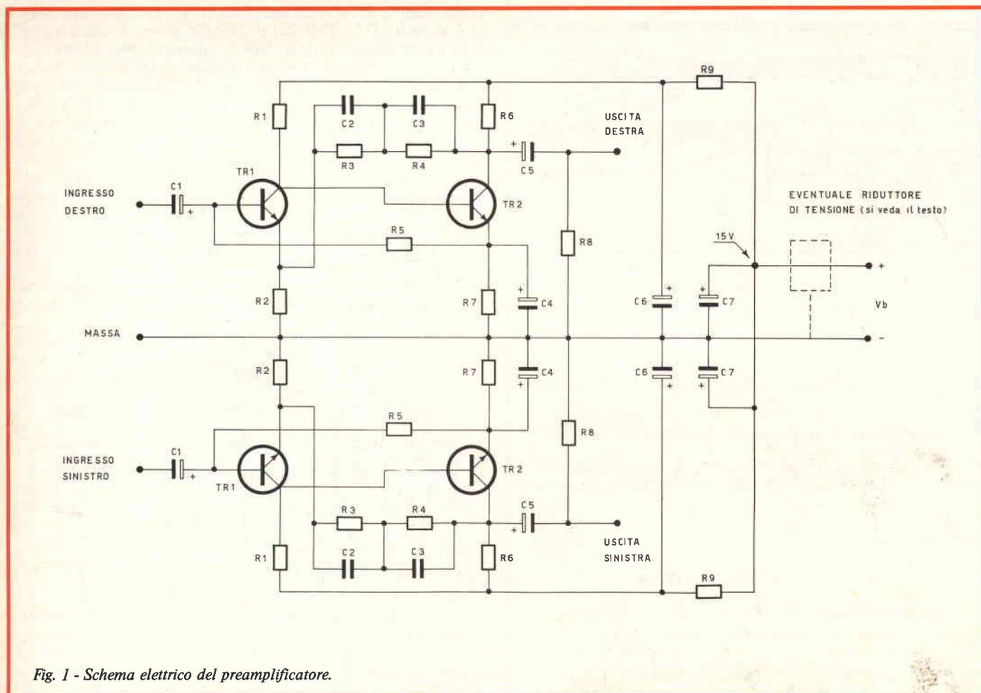
Fig. 1 - Schema elettrico del preamplificatore.
