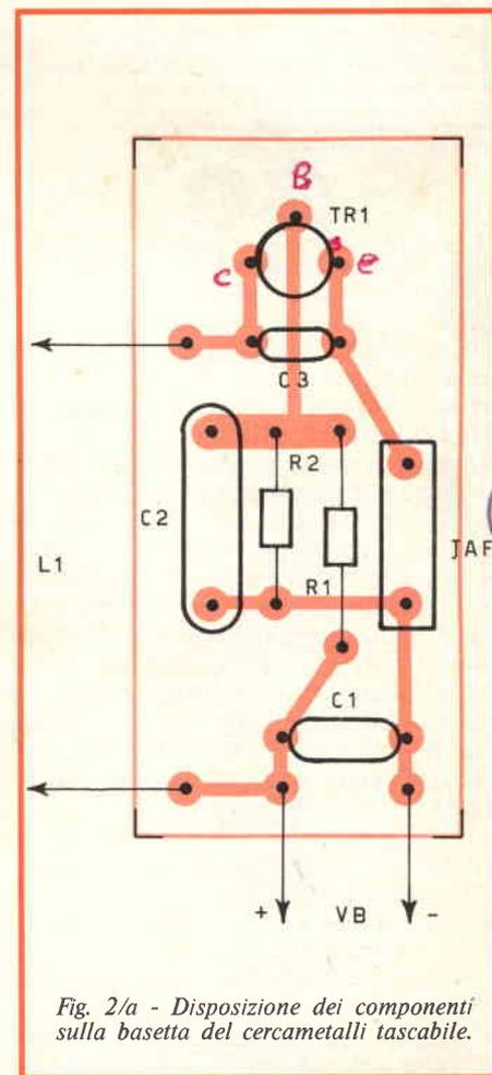
Fig. 2/a - Disposizione dei componenti sulla basetta del cercametri tascabile.
