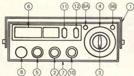
Fig. 1 - Disposizione dei controlli sul frontale.
