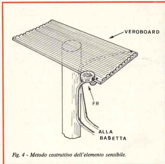
Fig. 4 - Metodo costruttivo dell'elemento sensibile.
