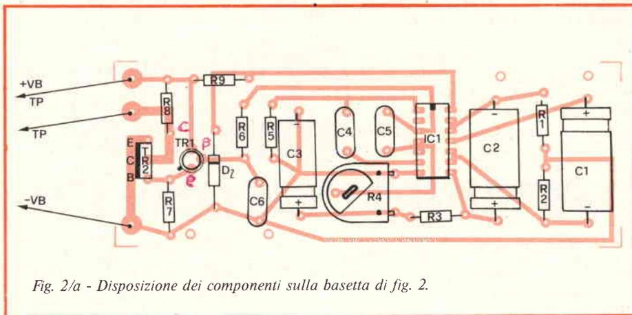
Fig. 2/a - Disposizione dei componenti sulla basetta di fig. 2.
