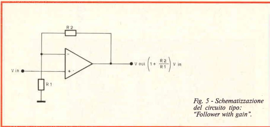
Fig. 5 - Schematizzazione del circuito tipo: "Follower with gain".
