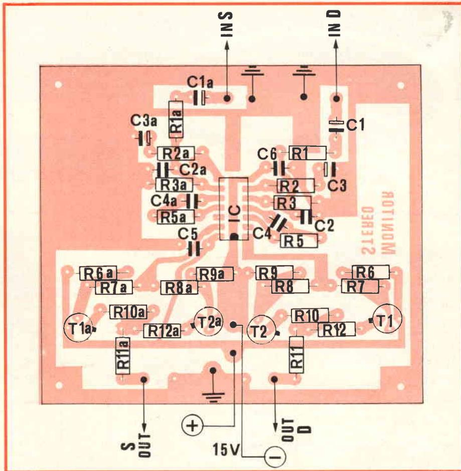
Fig. 3 - Disposizione dei componenti sulla bassetta
