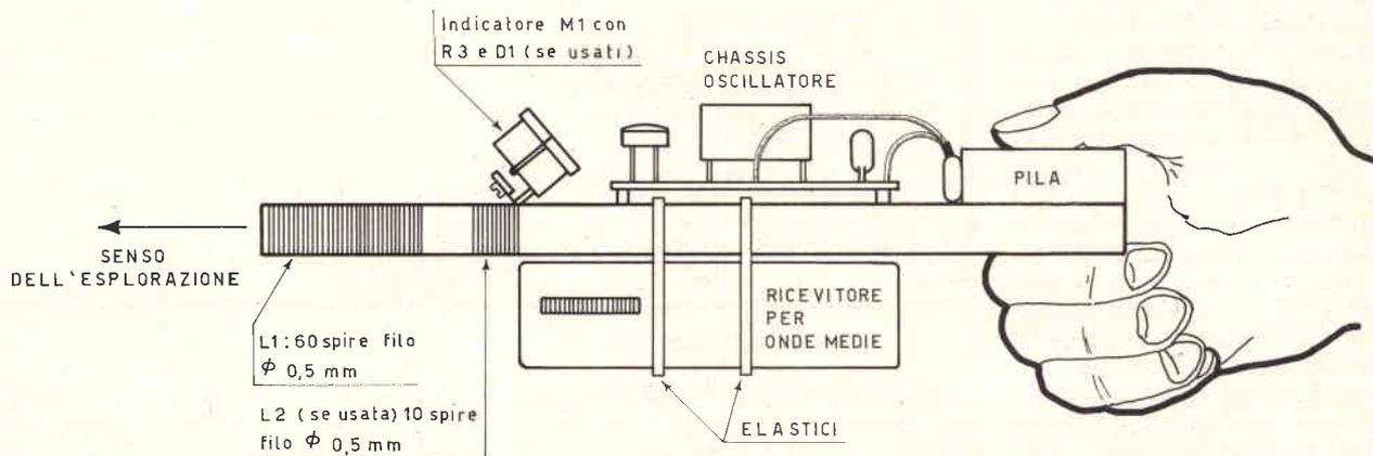
Fig. 4 - Il cercametri pronto per l'impiego.
