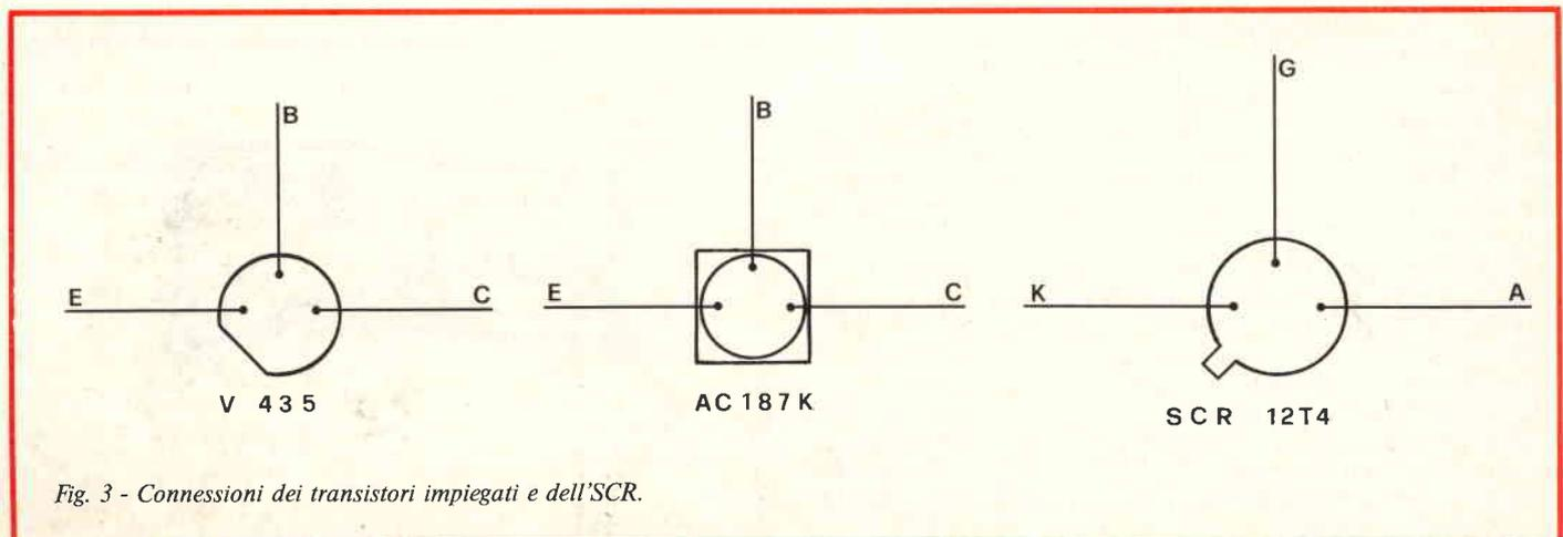
Fig. 3 - Connessioni dei transistori impiegati e dell'SCR.
